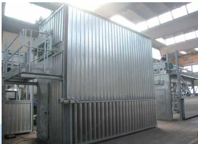
5) МАСЛООХЛАДИТЕЛЬ с усилителями турбулентности потока внутри труб и внешней рециркуляционной системой Завод: КАШАГАН РАЗРАБОТКА МЕСТОРОЖДЕНИЯ (КАЗАХСТАН) Нагрузка: 128 кВт; Расчетное давление: 6 бар; Установленная мощность: 6,6 кВт.
