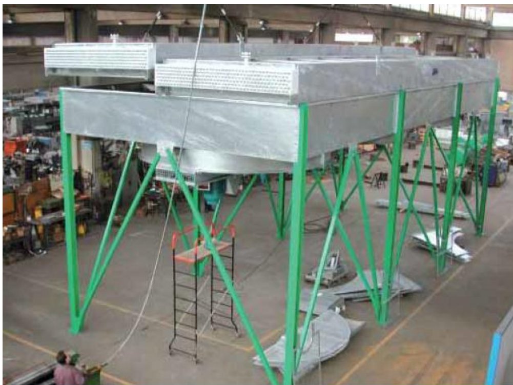
4) МАСЛООХЛАДИТЕЛИ Завод: МЕЛЛИТА (ЛИВИЯ) Нагрузка: 6400 кВт; Расчетное давление: 13 бар; Установленная мощность: 110 кВт.
