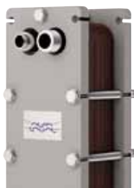
AXP52 — паяный пластинчатый теплообменник с тонкими внешними плитами, допустимое рабочее давление 130 бар. Предназначен для использования в системах на CO 2 с транс- и субкритическим циклом.
